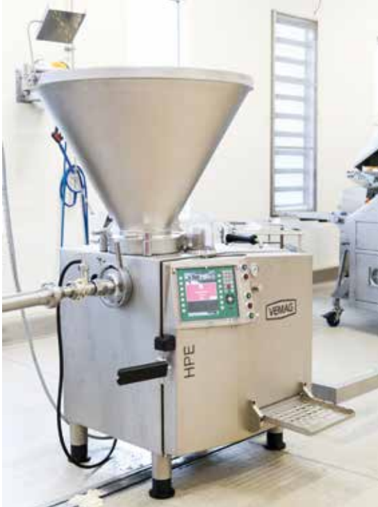
Vulmachine voor lijn 3, die voorafgaat aan de powerheater.
