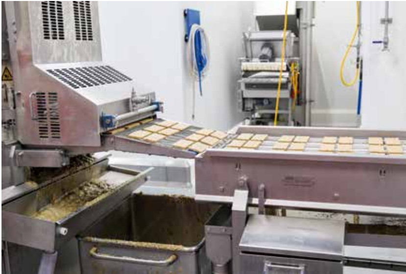
Het deeg wordt in de vormmachine in de juiste vorm geperst...
