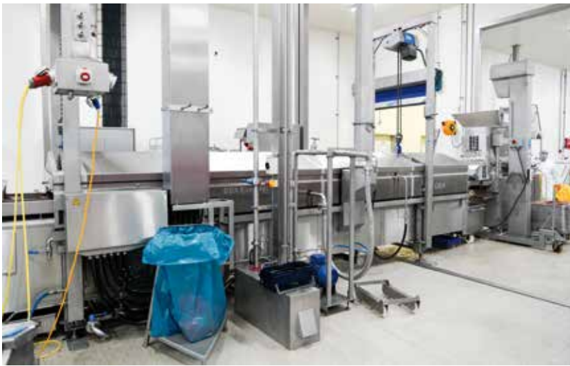
Overzicht van productielijn 2. Deze lijn combineert, net als lijn 1, een frituur en een oven.
