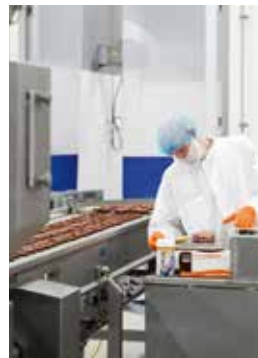
Een procesoperator voert een steekproef kerntemperatuurmeting uit tussen de frituur en de oven.
