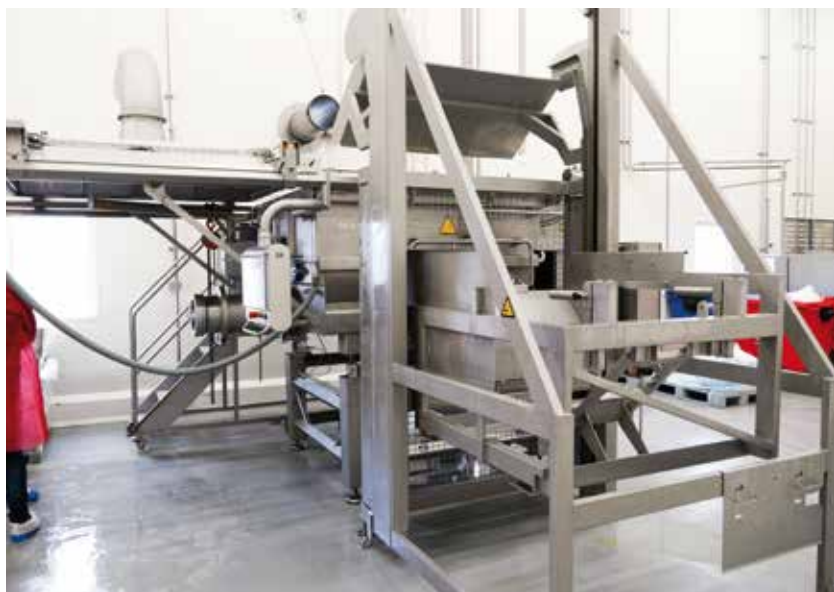
De mengerij. Alle grondstoffen worden centraal in de mengerij gemengd tot deeg, waarna het in de productielijnen wordt gebracht.
