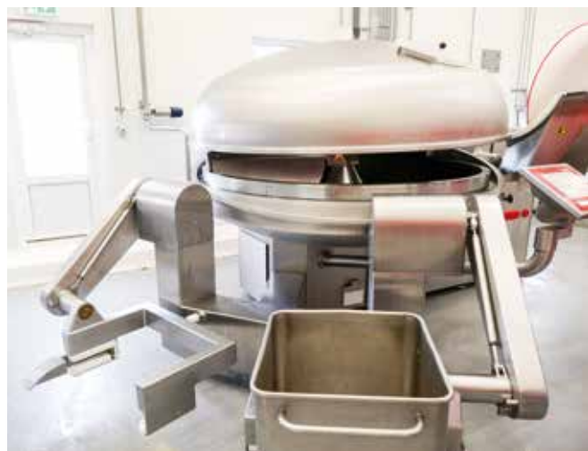
Cutter. Een groot ronddraaiend mes maakt zeer consistente emulsies. Bij producten waar de grondstoffen intact in het product moeten belanden (stukjes groente bijvoorbeeld) wordt deze cutter niet ingezet.
