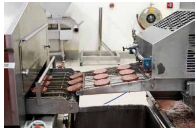
Na de vormmachine rollen de burgers op een roosterband de frituur in.
