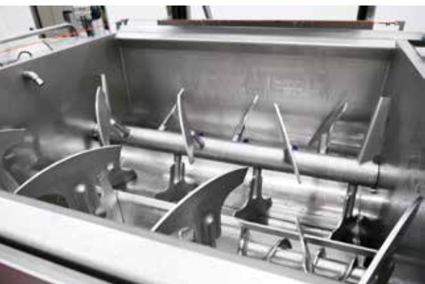
De mengerij. Alle grondstoffen worden centraal in de mengerij gemengd tot deeg, waarna het in de productielijnen wordt gebracht.
