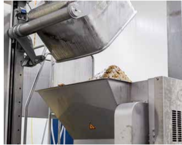
Het gereedstaande deeg wordt vanuit de stalen bakken middels een trechter in de vulopening gestort.
